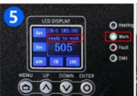
Когда на экране отображается «Ready to work», нагрев завершен и одновременно зажглись сигнальные индикаторы, устройство готово к работе
