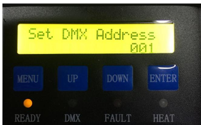
Нажмите кнопку UP или DOWN, чтобы выбрать значение от 1 до 512. Затем нажмите кнопку ENTER, чтобы вернуться в рабочий режим интерфейса или нажмите кнопку MENU для входа в интерфейс настроек температуры ядра. Интерфейс настроек температуры ядра показан ниже:
