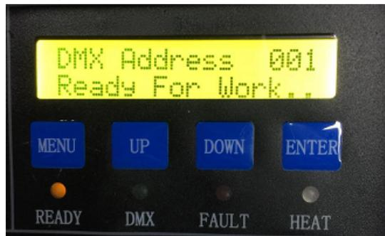
Примечание: Последние сохраненные данные «DMX Address» и «Ready For Work...» будут показаны в интерфейсе ожидания. Пользователь может включить режим нагрева при помощи пульта управления DMX или нажав на MENU для входа в рабочее состояние интерфейса.
