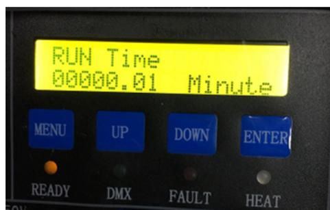
Примечание: После запуска устройства, на дисплее автоматически начинается отображение совокупного времени работы, включая фактическое время выброса искр, но без учета времени ожидания и прогрева. Совокупное время составляет не более 60000.00 минут с точностью до секунды. Если совокупное время переходит границу в 60,000 минут, система автоматически обнуляется и начинается перерасчет, как показано ниже:
