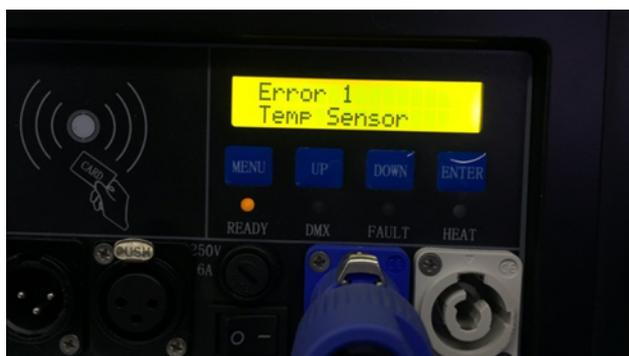
Если датчик температуры в исправном состоянии, нагрев начнется незамедлительно. Во время нагрева будет мигать индикатор HEAT. После нагрева устройства индикатор HEAT перейдет в режим OFF.
