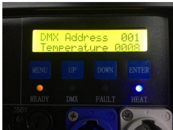
Когда спаркуляр работает, функция нагрева включается автоматически и появляются отображения адреса DMX и температуры ядра в настоящем времени. Если датчик температуры неисправен, индикатор FAULT начнет мигать, и на дисплее отобразится следующий интерфейс.
