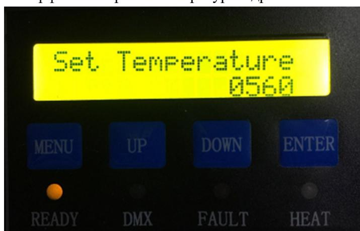
Нажмите кнопку UP или DOWN, чтобы установить температуру в промежутке от 560 до 620. Затем нажмите кнопку ENTER или MENU, чтобы вернуться в рабочий режим интерфейса.
